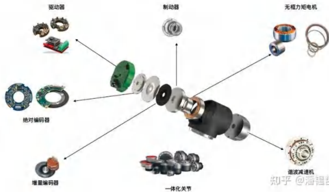
图表：机器人旋转关节模组拆解示意图
