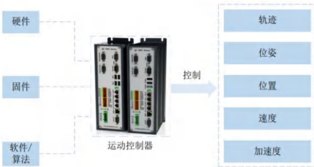
图表：运动控制器主要由硬件、固件、软件组成
