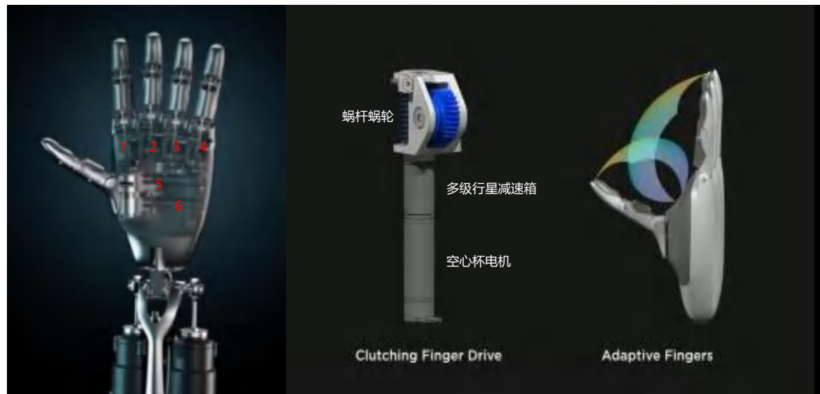
图表：特斯拉人形机器人手部关节示意图
