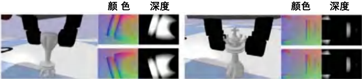
图2-13 Meta 开发的TACTO 模拟器在元宇宙中自主生成大规模触觉数据
