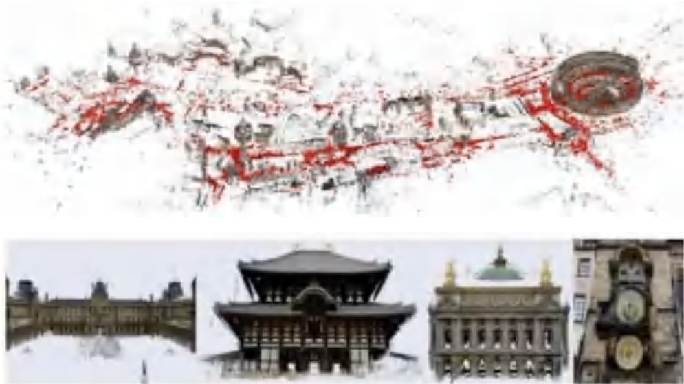
图3-13 COLMAP 实现SFM 和 MVS 的稀疏重建和稠密重建
