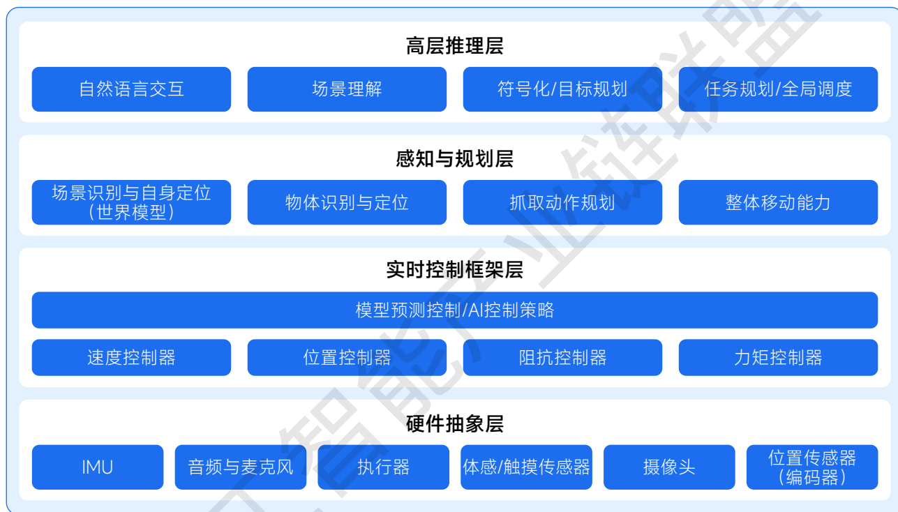
图3：人形机器人四层技术架构（来源：NVIDIA，芯查查）
