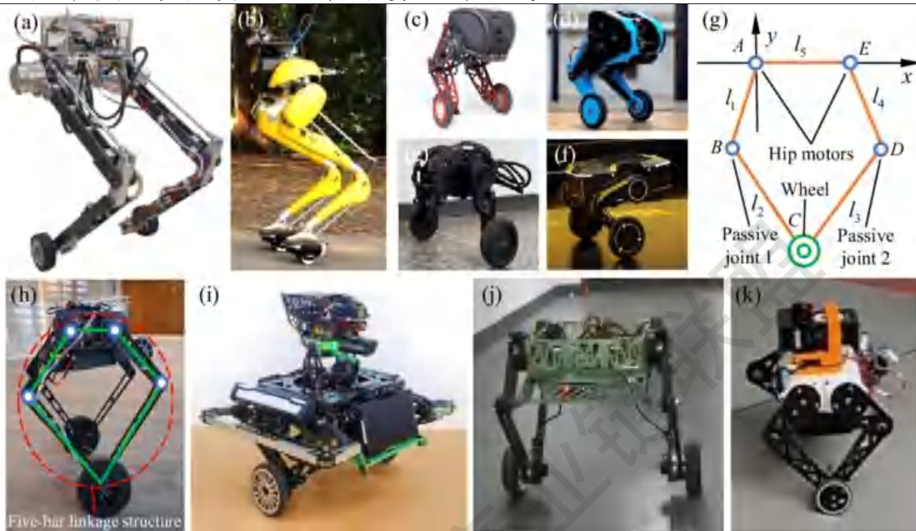
图33：轮足形态是足式与轮式的混合，设计较为复杂，目前使用较少
