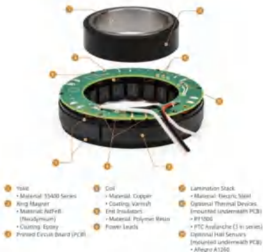
图15：无框力矩电机结构
